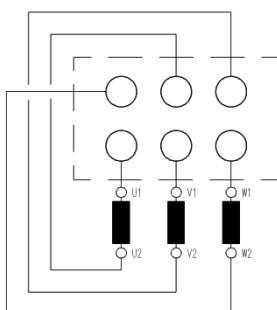
Для изменения направления вращения двигателя необходимо поменять местами две фазы на клеммах. Запрещается эксплуатация оборудования без подсоединеной клеммы заземления.
