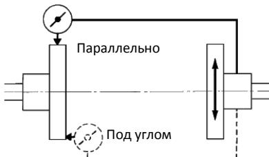
**⚠** При выверке параллельности максимальное показание индикатора в 2 раза больше фактического смещения вала.
