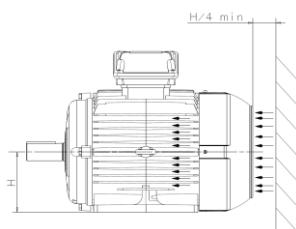
L'accéssibilité à la pompe pour les opérations de contrôle et de maintenance ultérieure doit être prise en compte.
