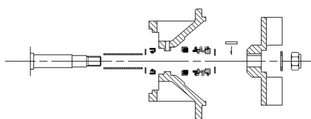
L'ensemble des joints doit être remplacé lors du remontage de la pompe. Veiller à ne pas plier/casser les joints plats en fibre ou PTFE.
