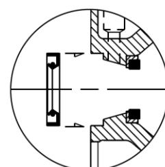
La garniture mécanique ne nécessite pas de réglage. La cote de réglage est donnée par construction.
