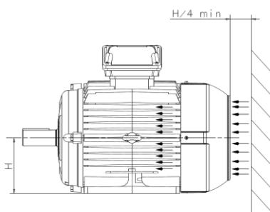
В месте установки должна быть обеспечена возможность доступа для техобслуживания и осмотров.
