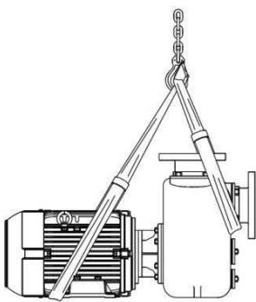
Подъем консольного насоса на стальной плите: Подъем консольного насоса на чугунной плите:
