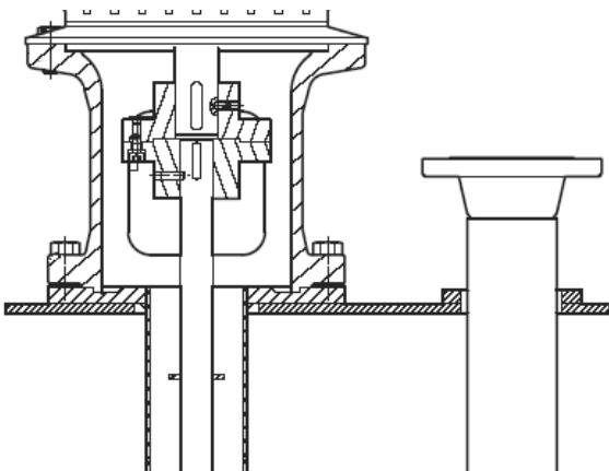
**VTM:** подшипниковый узел спроектирован с учетом использования усиленного шарикоподшипника с заданными размерами, который располагается между двигателем и присоединительным фланцем. Такая конструкция обеспечивает под фундаментной плитой длину более 1920 мм. Шарикоподшипники смазываются консистентной смазкой, а валы соединяются полуэластичными муфтами.
