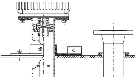
**VEM:** чугунное основание между опорной плитой и фланцем двигателя. Такая конструкция обеспечивает мощность до 18,5 кВт. Регулировка высоты насоса при этом невозможна. Между валом двигателя и штоком насоса установлена муфта прямого типа.
