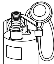
Для этого нужно ослабить клемму (зажим) поплавкового выключателя на ручке насоса. Поднять поплавковый выключатель до ручки,
