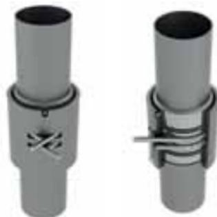
Водоподъемная труба с замковым стыковым соединением (ZSM) позволяет быструю установку, исключая применение соединительными болтами; необходим меньший диаметр скважины, так как соединения труб с использованием ZSM имеют меньшую толщину, чем фланцевые соединения
