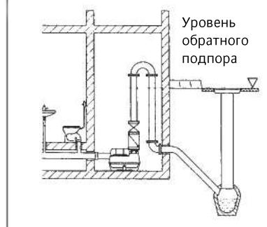
Использование петли защищает от затопления и обратных потоков.
