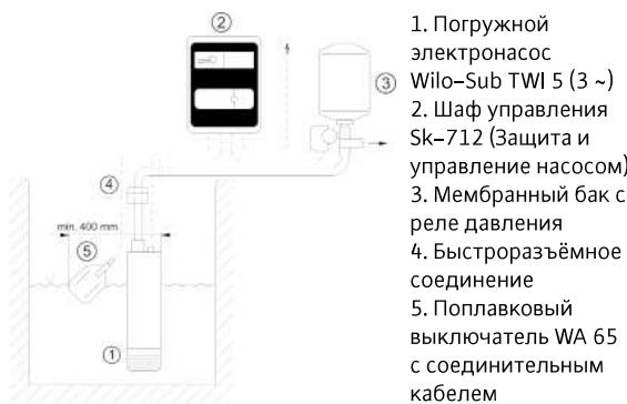
**Монтаж системы водоснабжения (трехфазная версия)**
