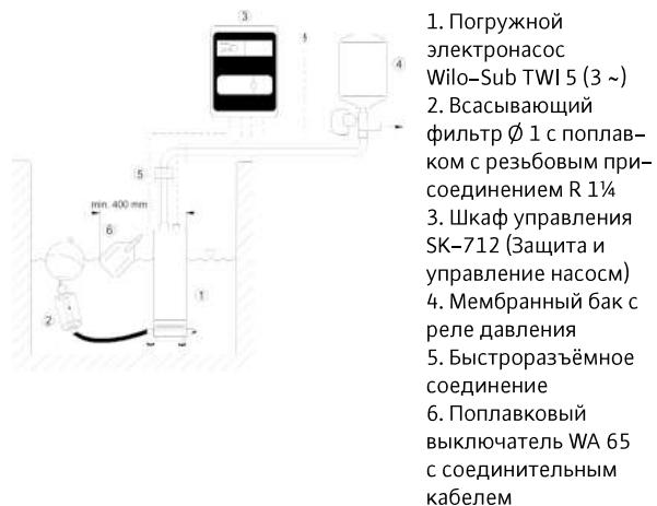
**Монтаж системы водоснабжения (переменный ток)**
