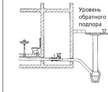
Допускается использование только обратного клапана в технических помещениях, но это не гарантирует 100% защиты от затопления.
