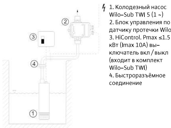
**Монтаж системы водоснабжения (однофазная версия)**
