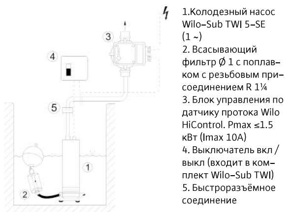
**Монтаж системы водоснабжения (трехфазная версия)**
