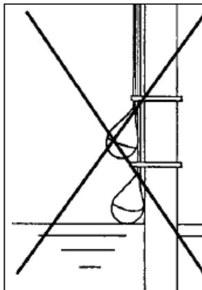
Поплавковый выключатель должен свободно висеть, не допускается, чтобы он лежал на дне, находился вблизи стен резервуара, арматуры и т.д., а также он не должен находиться непосредственно в зоне течения жидкости.
