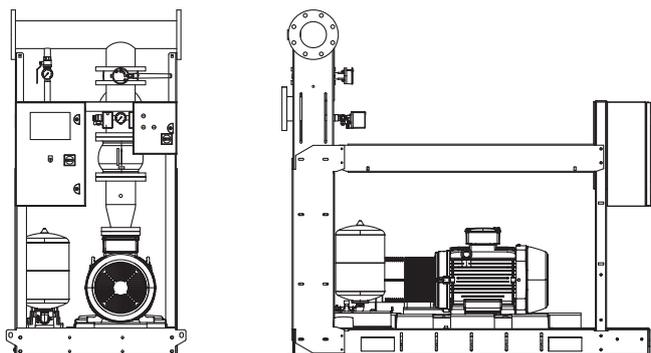
Sistema di pressurizzazione idrica antincendio a norme UNI EN 12845 e UNI 10779 preassemblato e collaudato in fabbrica, completo di 1 pompa principale di tipo back pull out accoppiata con motore elettrico mediante giunto e spaziatore e 1 pompa jokey ad asse verticale, completo di accessori idraulici e pannelli elettrici di controllo.
