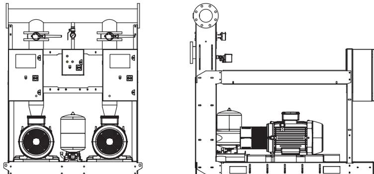
Sistema di pressurizzazione idrica antincendio a norme UNI EN 12845 e UNI 10779 preassemblato e collaudato in fabbrica, completo di 1 pompa principale di tipo back pull out accoppiata con motore elettrico mediante giunto e spaziatore e 1 pompa jokey ad asse verticale, completo di accessori idraulici e pannelli elettrici di controllo.
