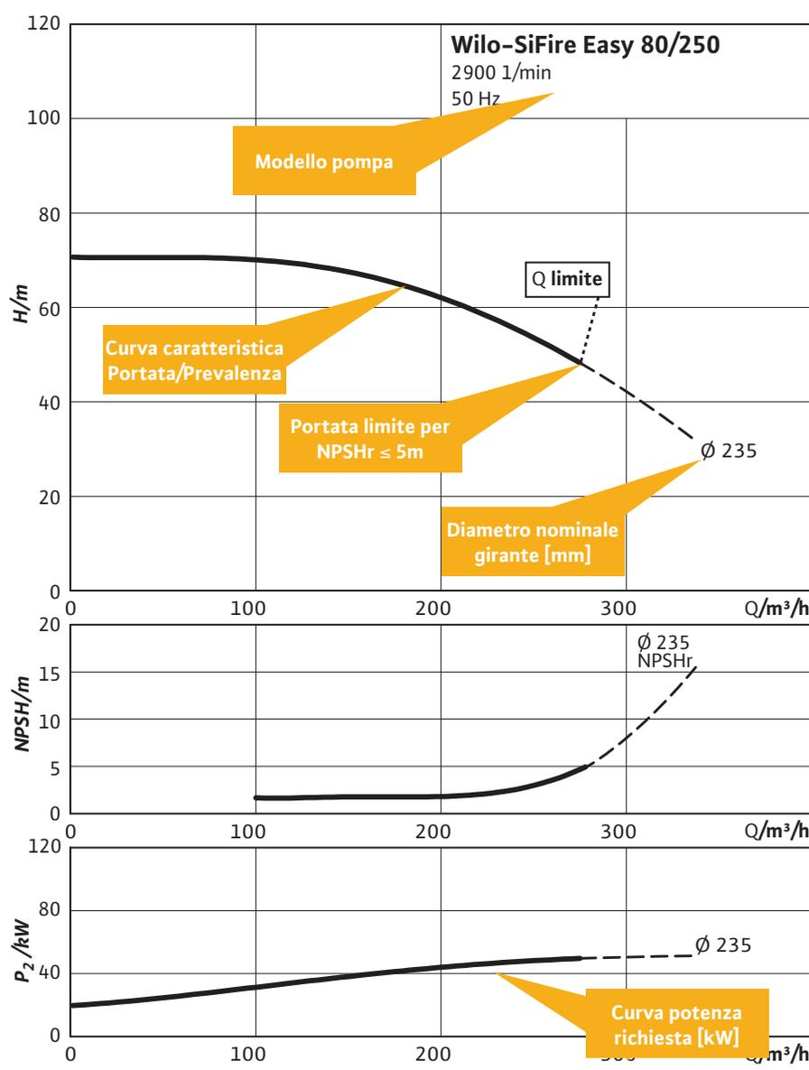
La parte della curva tratteggiata indica le prestazioni idrauliche ottenute con la pompa in sala prova per ottenere un valore di N.P.S.H = 16 m, al fine di individuare la potenza necessaria per alimentare la stessa. **Non è quindi da considerarsi utile ai fini del dimensionamento del sistema di pompaggio.**
