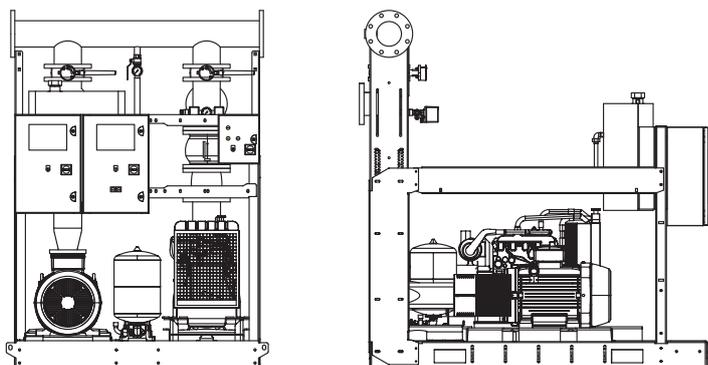
Sistema di pressurizzazione idrica antincendio a norme UNI EN 12845 e UNI 10779 preassemblato e collaudato in fabbrica, completo di 1 pompa principale di tipo back pull out accoppiata con motore elettrico mediante giunto e spaziatore, 1 pompa jokey e 1 pompa di riserva di tipo back pull out accoppiata con motore diesel mediante giunto e spaziatore, completo di accessori idraulici e pannelli elettrici di controllo.
