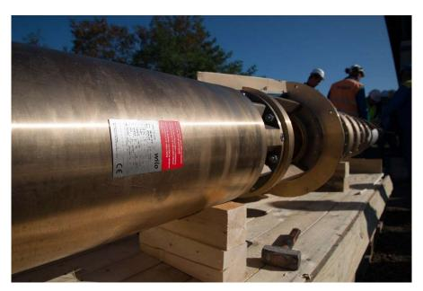
Capable de remonter et envoyer jusqu'à 500 m³/h d'eau brute vers la station de traitement, mais également de résister aux pressions et à l'érosion, la pompe Wilo-EMU K22 fut alors sélectionnée.
