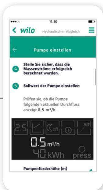
**7 Pumpe einstellen:** Nun zeigt die App Schritt für Schritt, welche Einstellungen an der Wilo-Stratos PICO plus vorgenommen werden müssen, um diese optimal an die Heizanlage anzupassen.
