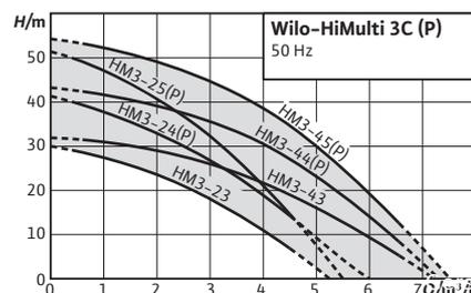
Die Baureihen sind verfügbar in normalsaugender Ausführung (HiMulti 3...) oder selbstansaugender Ausführung (HiMulti 3... P).
