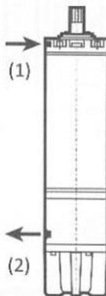
**Рисунок 2** Заполнение двигателя при вертикальном монтаже
