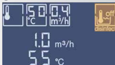
Durante il ciclo di **disinfezione termica** il generatore di calore si riscalda periodicamente insieme all'accumulatore di acqua calda sanitaria. In questo periodo il circolatore funziona con un numero di giri leggermente elevato e garantisce la disinfezione dell'impianto.
