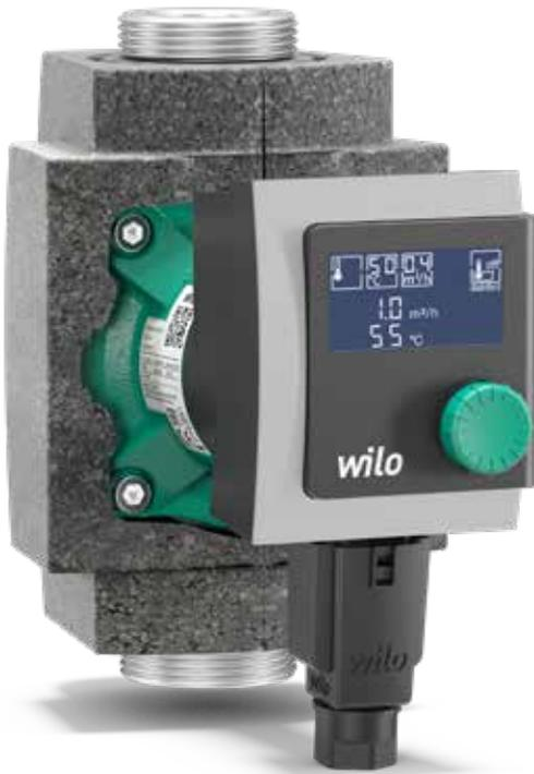
Dank einfacher Installation und Inbetriebnahme ist das Trinkwarmwasser-Zirkulationssystem im Haus schnell und sicher geschützt vor Legionellen. Die Premium-Hocheffizienzpumpe Wilo-Stratos PICO-Z unterstützt automatisch die thermische Desinfektion des Trinkwarmwasserspeichers. Ab einer eingestellten Temperatur von 55 °C wird die Gefahr von Keimbildung im Zirkulationssystem vermindert.
