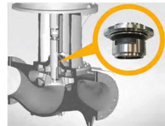
Wilo-IL комплектуется уплотнениями Burgmann AQ1EGG или Q1Q1X4GG в картриджном исполнении из нержавеющей стали, что позволяет легко осуществить их замену без демонтажа насоса, без снятия мотора и без специальных приспособлений в течении 30 минут согласно прилагаемой инструкции.
