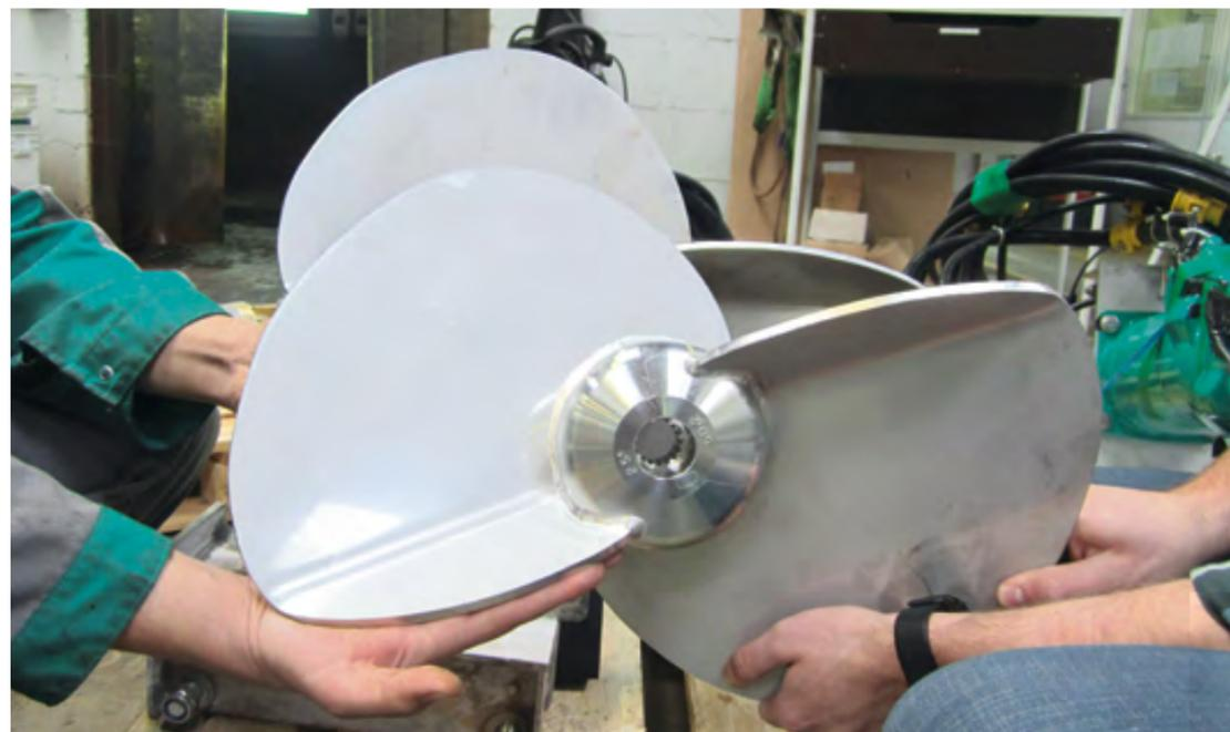
Даже после 25 000 часов работы на погружной мешалке Wilo для промывочного бурового раствора наблюдаются минимальные следы износа по сравнению с новой мешалкой.
