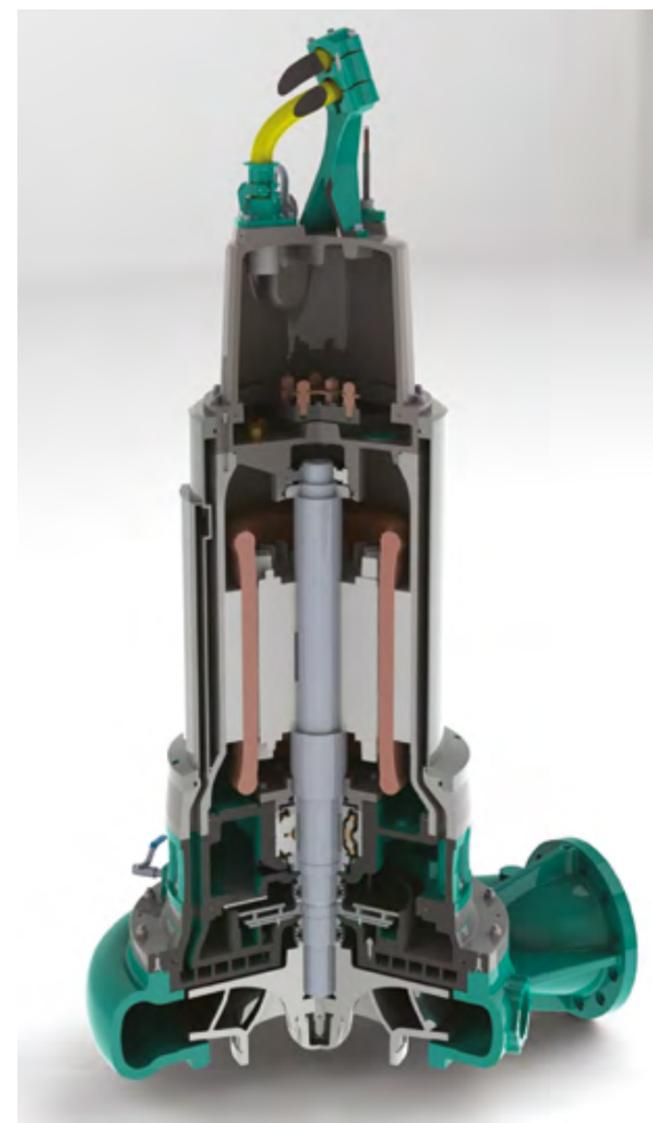
Насос оснащен закрытой рубашкой охлаждения с циркулирующим хладагентом. Закрытая конструкция рубашки защищает поверхность статора от накипи и коррозии, тем самым увеличивает срок службы агрегата.
