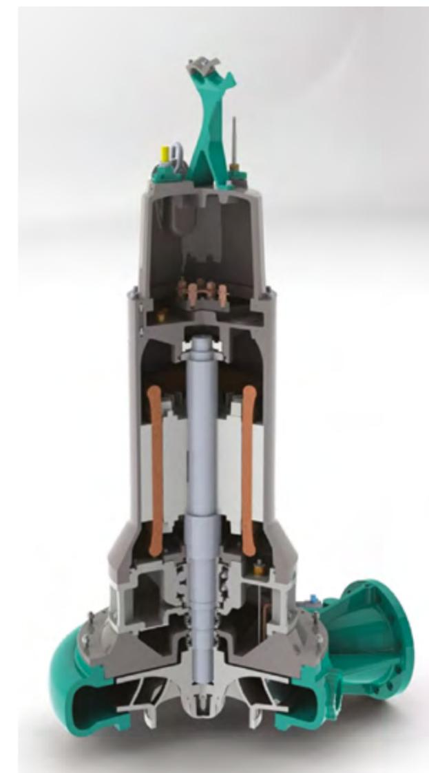
При установке агрегата непосредственно в резервуар или приемную камеру, где насос всегда работает в погружном состоянии, можно сэкономить на рубашке охлаждения и упростить конструкцию.
