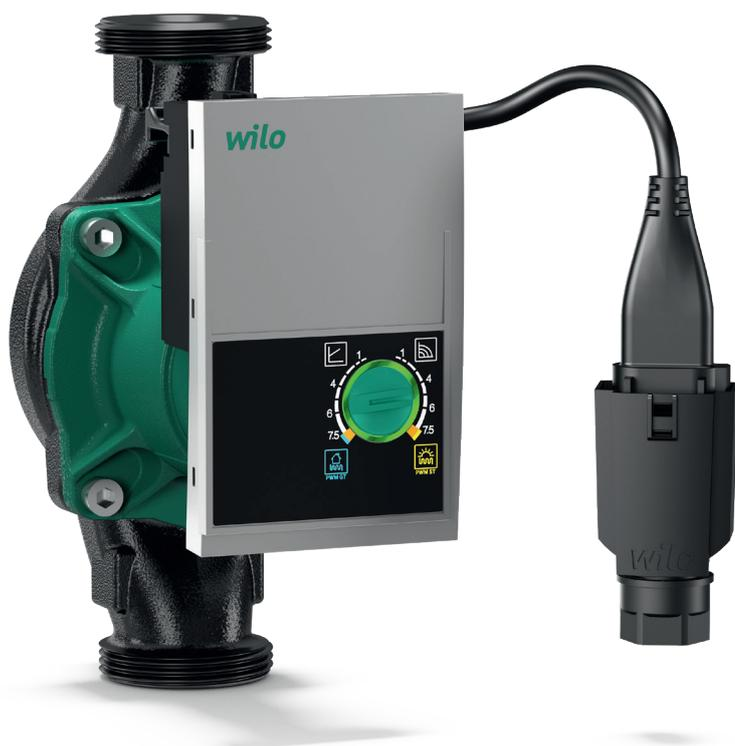
Le circulateur à rotor noyé avec moteur EC à haut rendement et adaptation électronique de la régulation de puissance intégrée convient tout particulièrement aux circuits primaires d'installations solaires et géothermiques.
