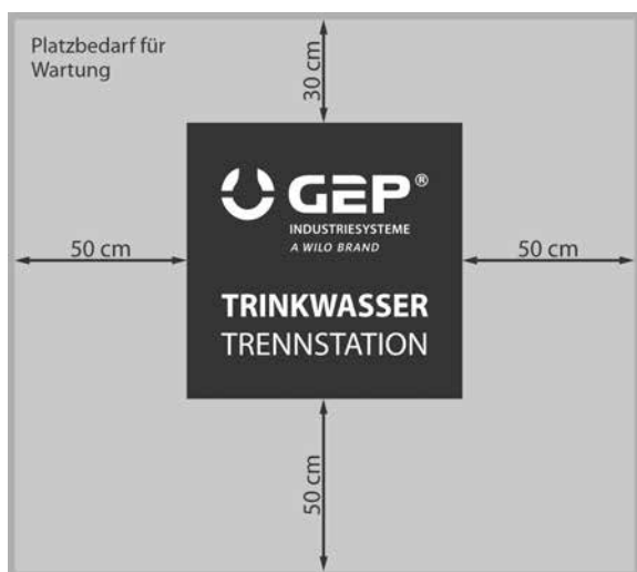
Abb.: Anlage ohne Vollverkleidung
