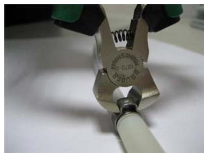
Das Kabel wird durch die hierfür vorgesehene Öffnung des Mauerdichtungselementes geschoben. Das Stützrohr sollte mit geeignetem Gleitmittel versehen werden und in die Durchführung geschoben werden. Wenn das Stützrohr eingeführt wurde, wird auf der abgehenden Seite des Stützrohrs, wie vorstehend, der Schlauch und die Schelle aufgezogen und die Schelle verquetscht.
