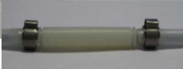
Im Anschluss kann das Steuerkabel **mit** Schlauch in den Klemmkasten fachgerecht eingeführt und aufgeklemmt werden. Bei der Kabeleinführung in diesen ist analog der Installationsbeschreibung des Dichtungselementes zu verfahren. Es ist ein atmosphärischer Luftausgleich im Belüftungsschlauch des Sensors dauerhaft zu gewähren.
