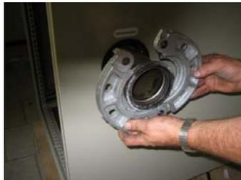
3. Schrauben zur Flanschbefestigung einführen und Klappflansch mit Zange festhalten, um ein Auseinanderklappen zu vermeiden.
