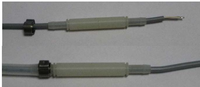
Das Stützrohr wird bündig auf den Schlauch aufgeschoben. Die Schlauchschelle wird auf die Schlauchtülle geschoben und mit einer geeigneten Zange verquetscht.
