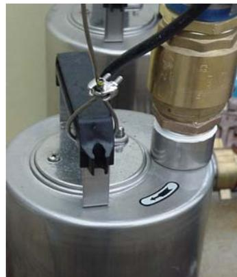
5. Anbinden der bauseitigen Druckleitung an Schlauchanschluss.
