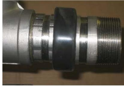
2. Kupplung auflegen und festziehen. Die Nuten der Kupplung greifen in die Rollnutnaht.
