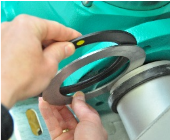
Anordnung Gummiflanschdichtung und Beilagscheibe.
