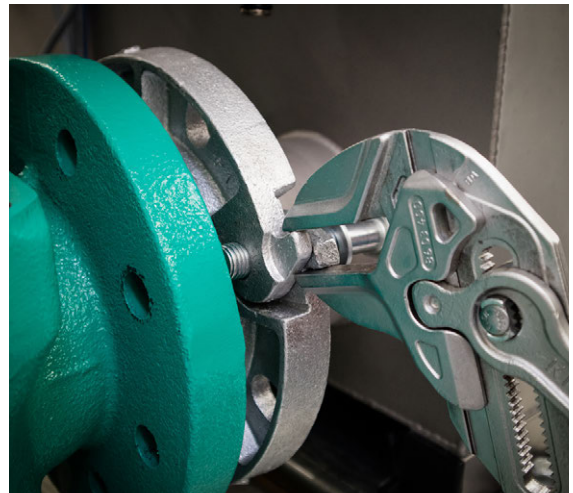
Klappflansch Öffnung drehen zum Fixieren
