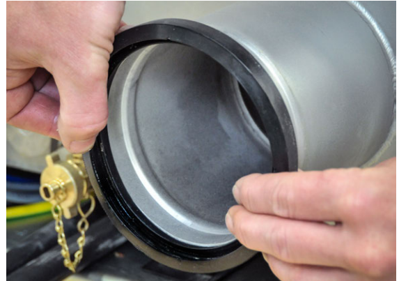
Dichtung auf Saugstutzen montieren
