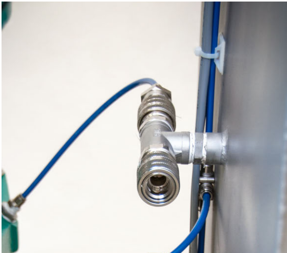
Anschluß Pumpenentlüftungen an Schnellkupplungen Behälter
