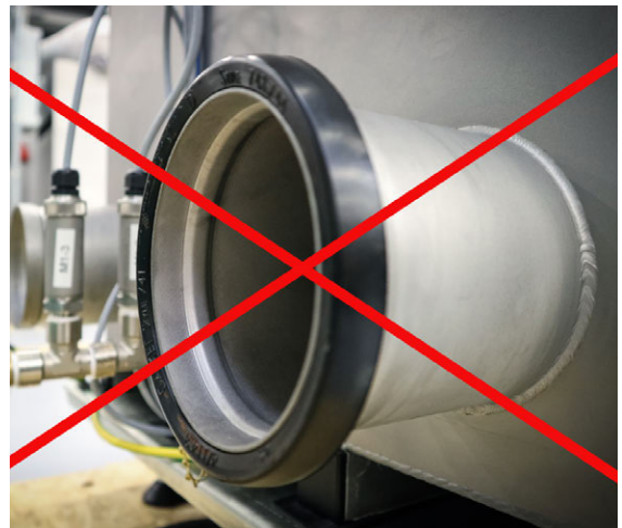
ACHTUNG! Falsch montierte Dichtung.
