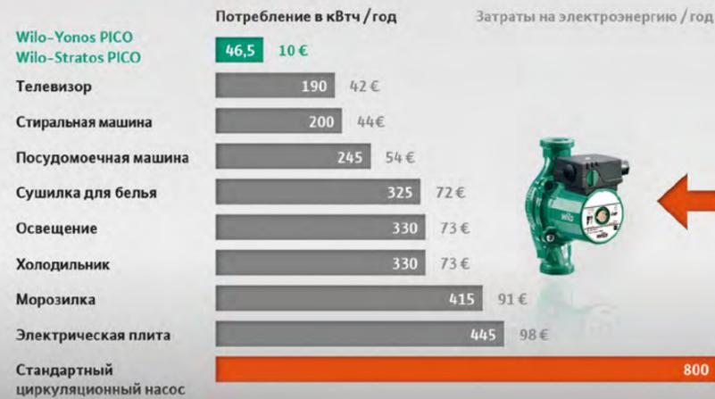
Директива о требованиях экологического производства продукции, связанной с энергосбережением, для циркуляционных насосов с мокрым ротором (предписание (ЕС) 641/2009 и (ЕС) 622/2012) устанавливает все более жесткие значения эффективности. Оборудование Wilo выполняет эти требования уже сейчас.
